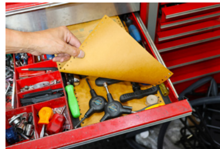
ツールキャビネットの引き出しには錆ニクを敷き詰め、さらに載せている。
